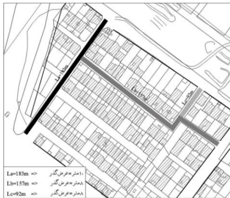
شکل شماره ( ۲ ) نحوه تعیین طول کوچه بن‌باز (بافت پر)
